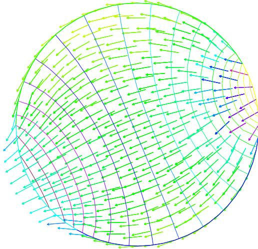
図 2: sample1.edp の結果 ( $\theta \in [0, \pi/6]$  で勢い良く入り、 $\theta \in [\pi, 4\pi/3]$  でゆっくり出て行く)
